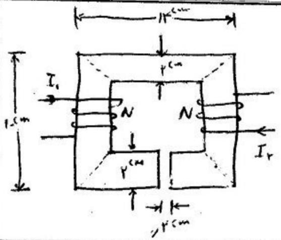
۱ شکل روبرو یک مدار مغناطیسی است که دو سیم پیچ است و هسته نرم با نفوذ مغناطیسی بی انتها است. ضخامت هسته  $13\text{cm}$  است و داریم شار در هسته چندانست. ضمناً چیرا در شکل هالی قدرت ولتاژ را با نامی بریم؟
